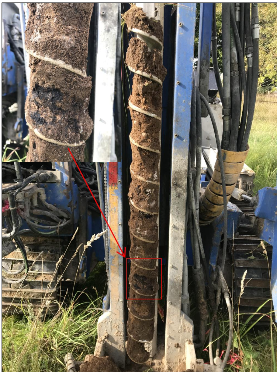
Figur 6. Jord på skruvborr från 0 – 1 m u my i provpunkt 21W02, notera närbild på ev. asfaltsrester.
